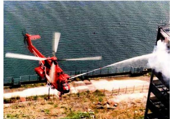
東京消防庁・可動ブーム式空中消火システム試作、消火液放射試験
