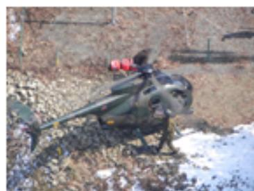
第9飛行隊が実施した通信所への燃料空輸(OH-6)
